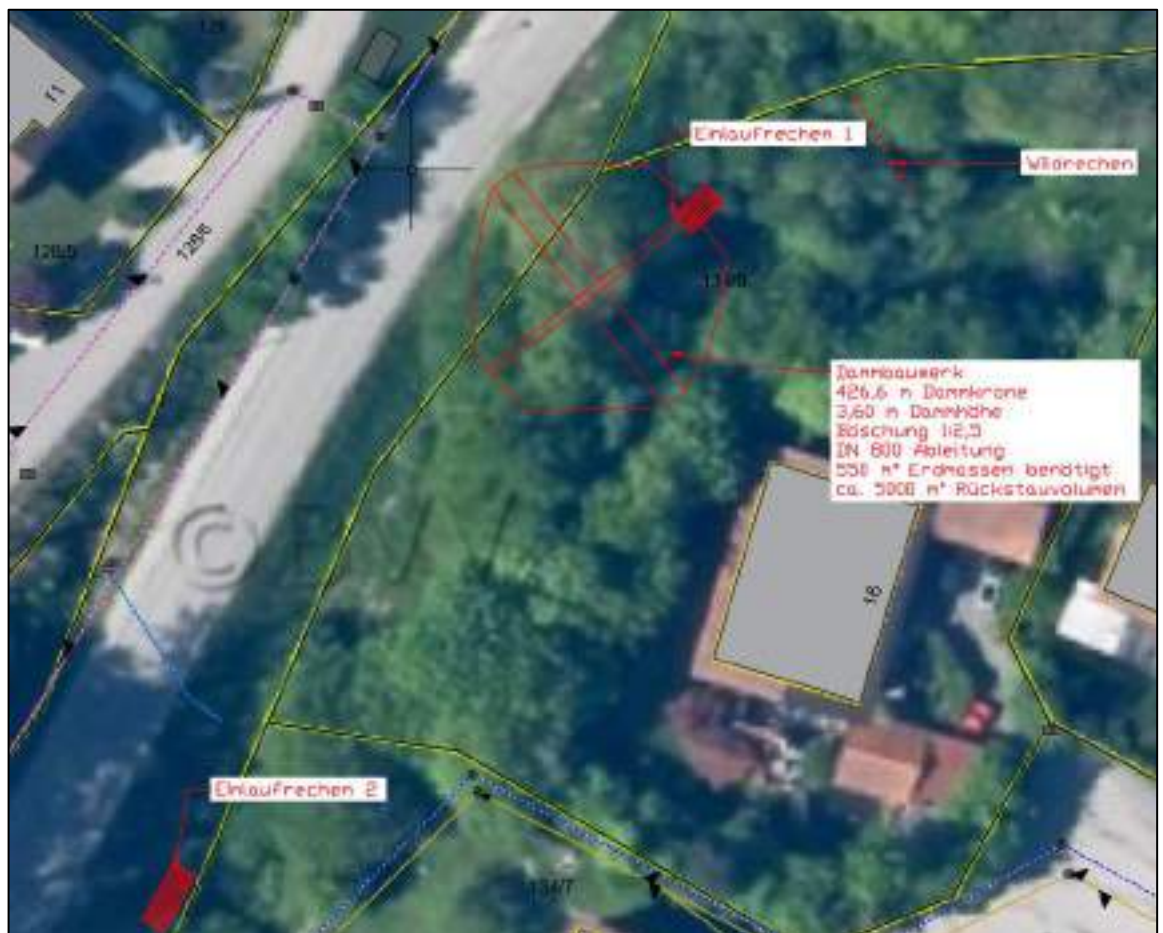
Abbildung 41: Dammbauwerk / HRB Erlbacher Straße
