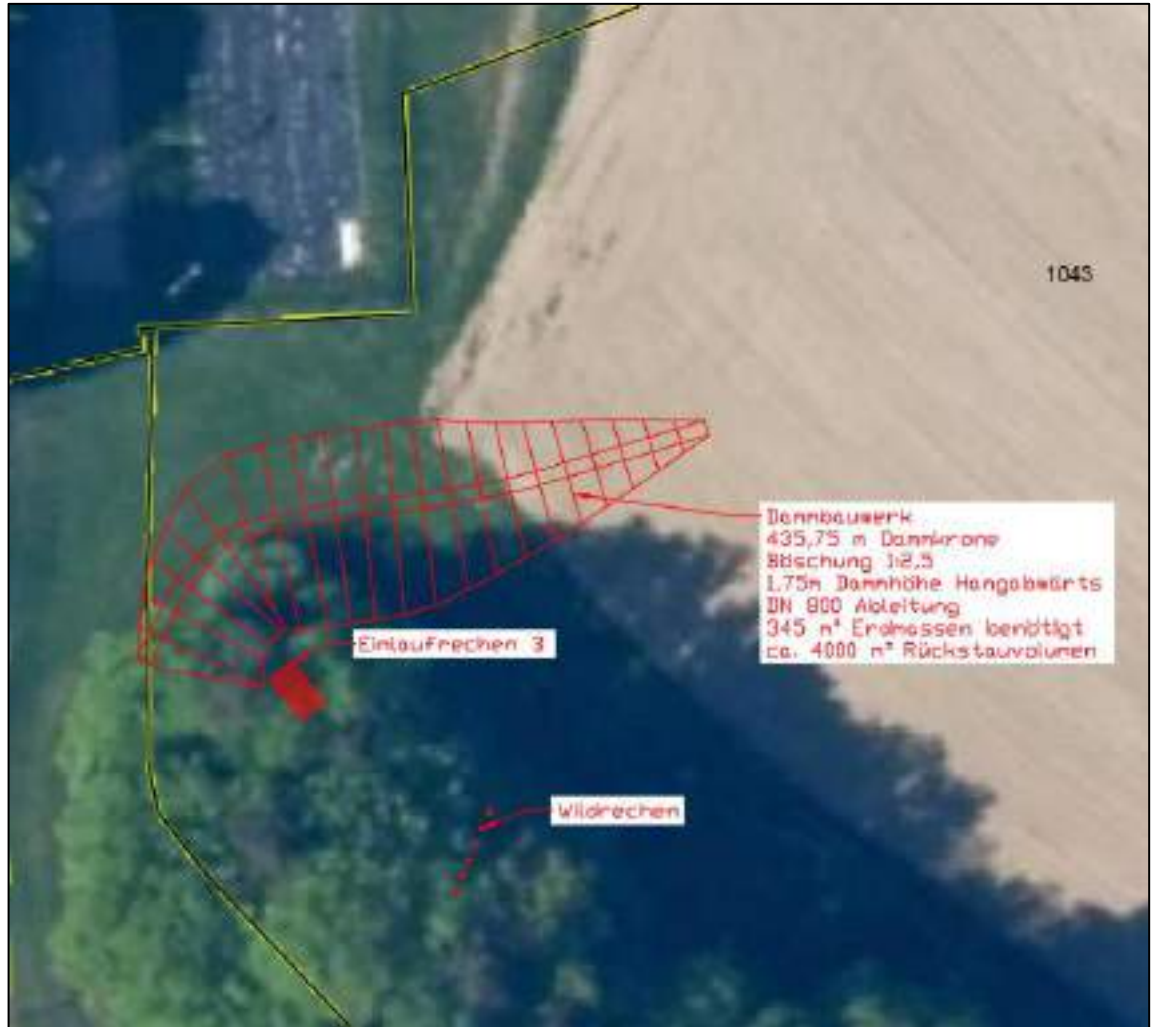
Abbildung 42: Dammbauwerk / HRB Staudenhäuser Graben
