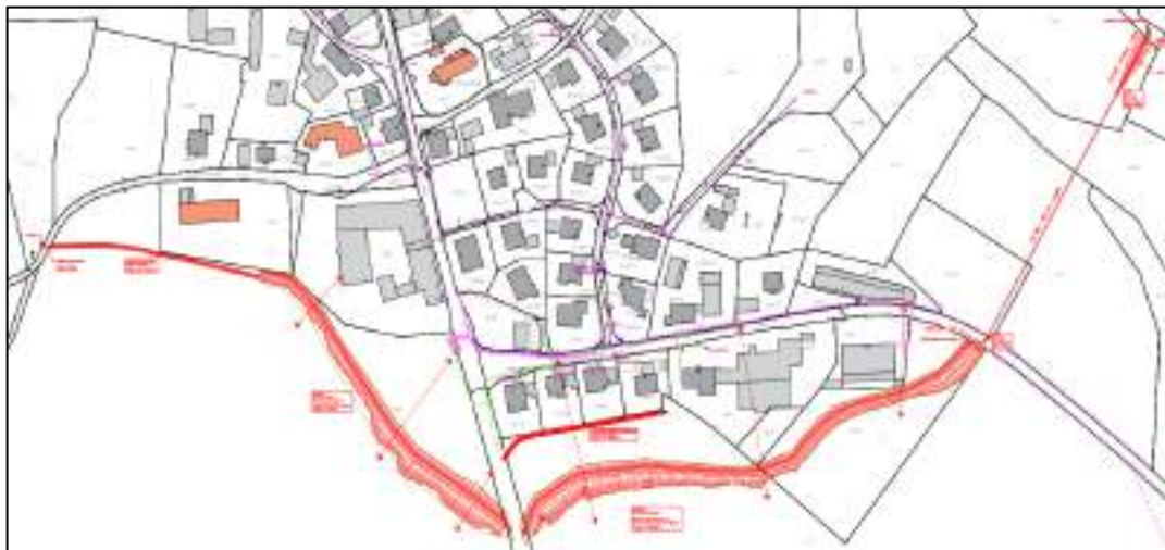
Abbildung 38: Dammbauwerke zur Umlenkung von wild abfließendem Wasser in Arbing
